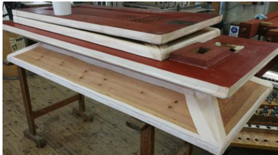
Istandsæt faltebælg og pumpebælg. Bælg er malet, for at skjule de udskiftede træpartier.
